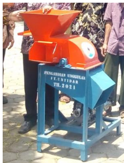
Gambar 5. Mesin pencacah sabut kelapa muda
