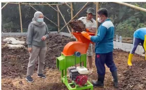
**Gambar 5.** Uji coba mesin pencacah pupuk organik di tempat produksi
