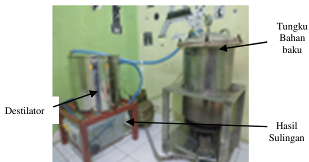
Gambar 2. Unit penyulingan komponen aromatik bunga kopi yang digunakan
