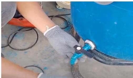
**Gambar 2.** Pemasangan Kran Air untuk tempat keluar Pupuk Cair
