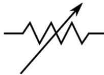
Gambar 2 Simbol Resistor Tidak Tetap
