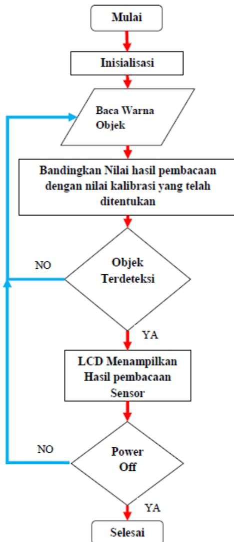
**Gambar 11. Flowchart Diagram Alat Pendeteksi Kesegaran Ikan**
