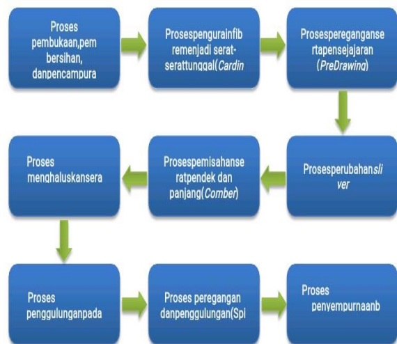
Gambar 1. Diagram proses produksi mesin PT. Budi Texindo Prakarsa (Sumber: Dokumentasi Pribadi, 2020)
