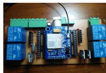
Gambar 21. Pemasangan Komponen pada PCB
