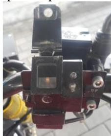
Gambar 25. Pemasangan Fingerprint pada Stang Sepeda Motor
