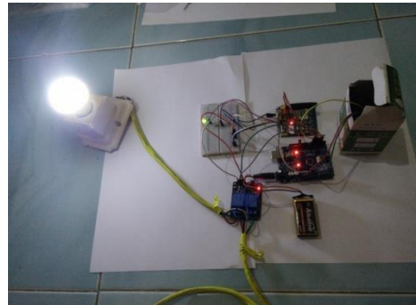
Gambar 18. Lampu Menyala ketika Mendeteksi Keberadaan Orang
