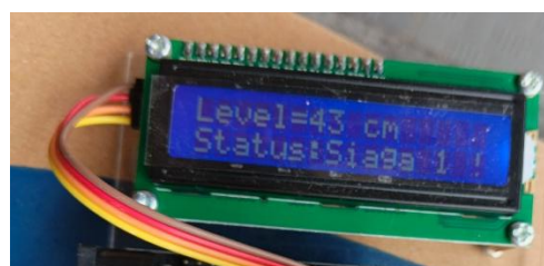
Gambar 12. Contoh tampilan LED sesuai status tinggi Air Siaga satu
