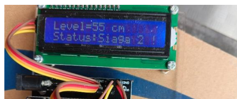
Gambar 13. Contoh tampilan LED sesuai status tinggi Air Siaga dua
