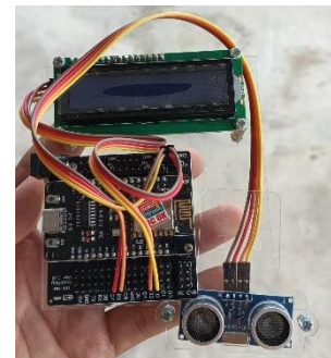
Gambar 8. Wujud fisik prototipe pendeteksi ketinggian air berbasis NodeMCU
