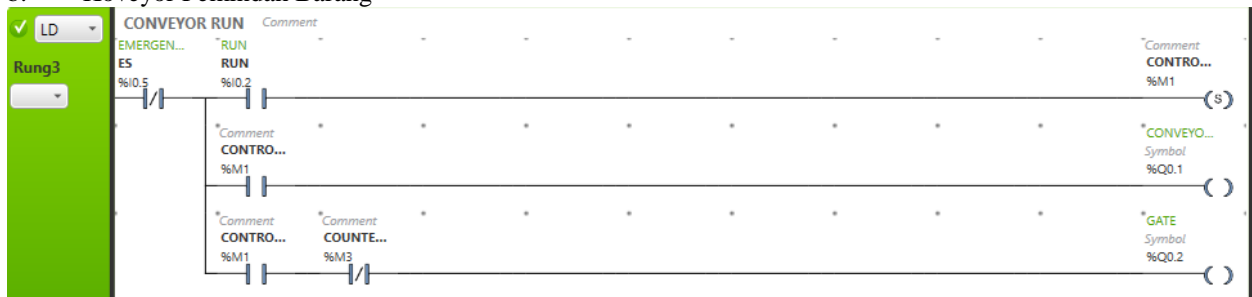
Gambar 11. Program Awal untuk Menghidupkan Konveyor
