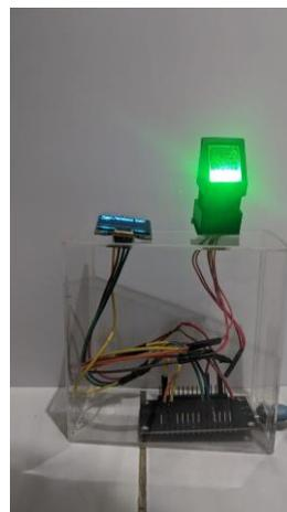
Gambar 9. Konfigurasi Perangkat Keras Sistem Absensi dengan Sensor Sidik Jari
