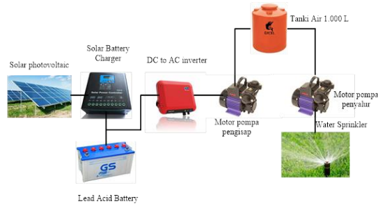
Gambar 4. Automatic Watering Sistem Dengan Suplai Daya Dari PLTS
