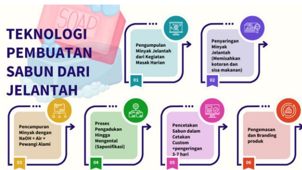
Gambar 1. Alur pembuatan sabun dari minyak jelantah
