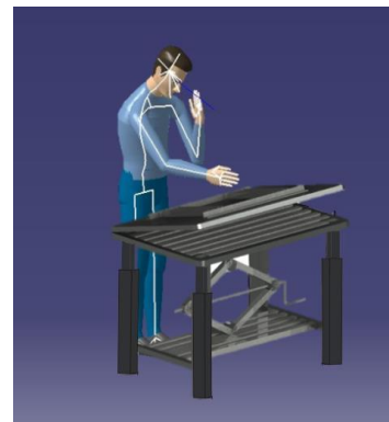
Gambar 5. Pengujian Simulasi Model Manusia dengan Konsep Desain Meja Kerja Pengelasan
