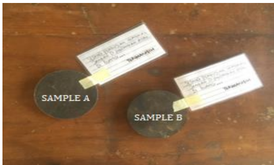
Gambar 9. Sampel yang Digunakan untuk Menghitung Penambahan Korosi
