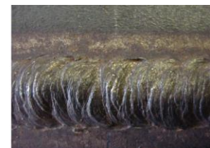
Gambar 2. Cacat Las undercut
