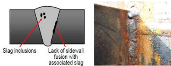
Gambar 4. Cacat Las Slag Inclusion
