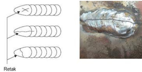
Gambar 5. Cacat Las Crack (retak)
